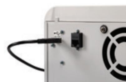
**Trousse USB** Téléchargez les données des cycles, y compris la durée, la température et la pression. Comprend une clé USB, un câble USB et une carte PC (installation par un technicien requise).
